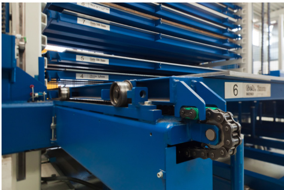
Zieh-/Schiebeeinrichtung mit Mitnehmer zum ein- und auslagern von Blechen.
