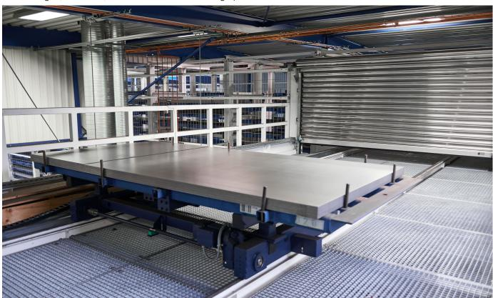
Über die Pendelstrecke, die über eine Brücke führt, lässt sich jede Laserschneidanlage aus beiden Lagersystemen versorgen
