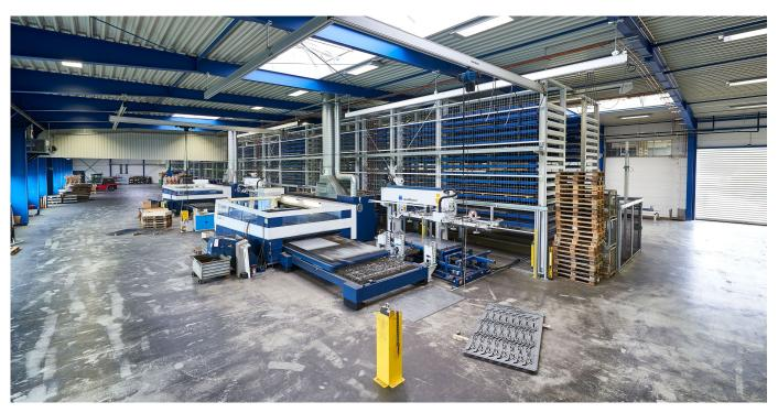
Dreeskornfeld hat in eine zweites automatisches Blechlager investiert, das für vier Systempalettenformate, einschließlich des Maxiformats XF, ausgelegt ist
