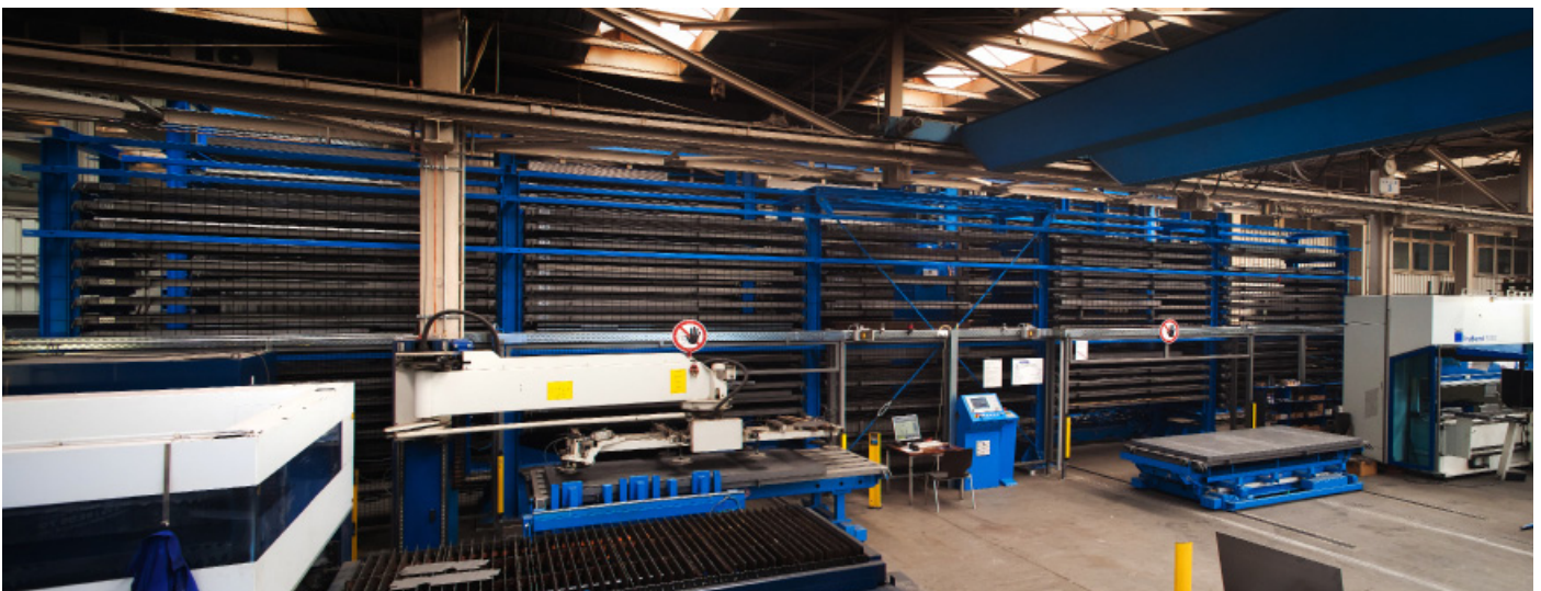
Durch einen Transportwagen und eine Beladeeinrichtung ist die Trumpf-Laserschneidanlage automatisch an das Blechlager angebunden.
