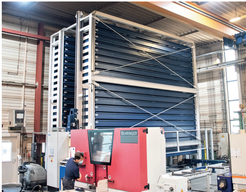
Le magasin pour produits longs STOPA LG-E se caractérise par un haut degré d'exploitation de l'espace, une productivité accrue et un accès rapide au matériel
