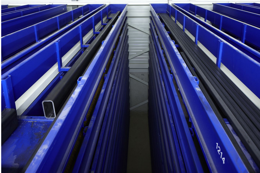
Das von STOPA gelieferte Langgutlager bietet einen hohen Raumnutzungsgrad sowie schnelle und wahlfreie Zugriffe auf das
