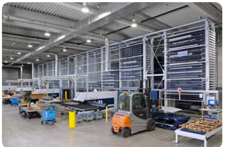
Der Gabelstapler legt das Blechpaket auf die Ablagestempel der Wareneingangsstation. Das Blechpaket kann so schadensfrei positioniert werden und die Gabel lässt sich einfach wieder herausziehen.
