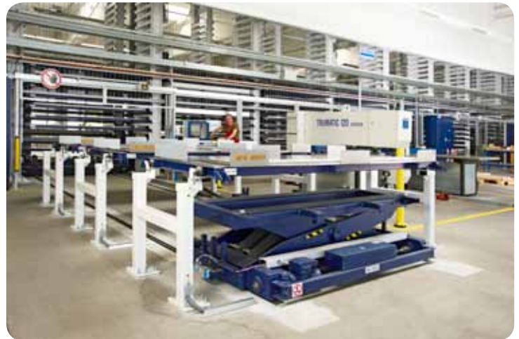
Die drei Ablagegestelle puffern Paletten mit Blechpaketen und sichern so den Nachschub der angebotenen Maschine. Der Scherenhubtisch kann durch Absenken unter den Paletten durchfahren.
