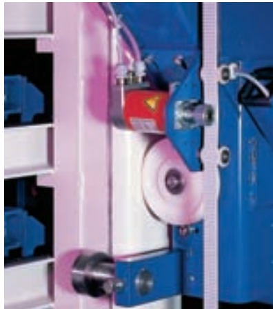
Lastunabhängiges Wegmeßsystem für exakte Höhenpositionierung
