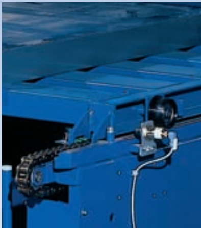
Palettenpositionsschalter auf dem RBG
