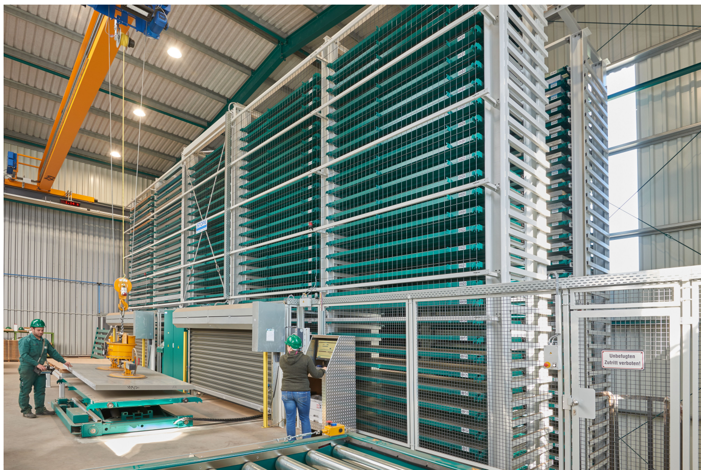
Das STOPA WMS 4.0 des Automatiklagers kommuniziert mit dem übergeordneten ERP-System und mit den zu versorgenden Sägeanlagen
