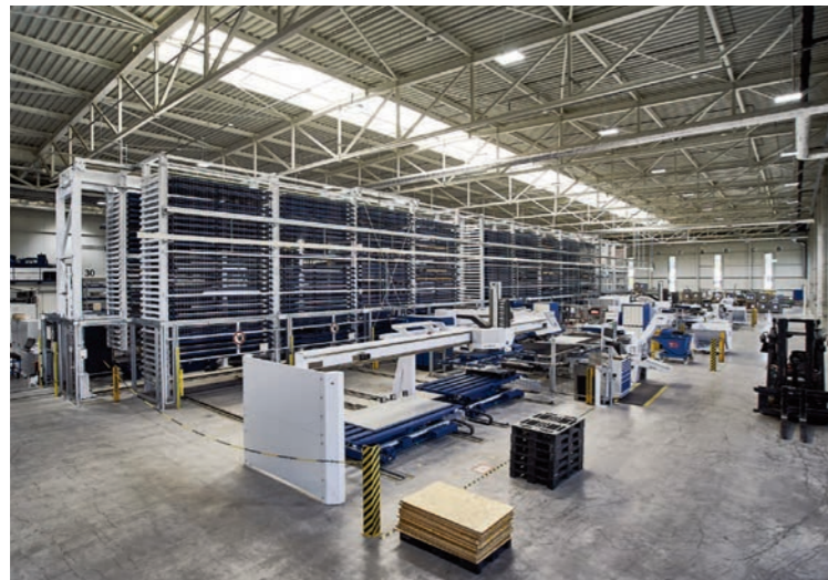
Chez BINDER, le magasin de tôles automatique STOPA COMPACT II joue le rôle de centre logistique interne.
