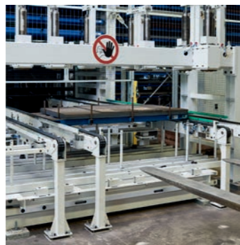
L'un des points forts du magasin grande capacité STOPA UNIVERSAL installé chez Dreeskornfeld est sa station d'entrée des marchandises qui permet de mettre en stock les quatre formats de feuilles de tôle.
