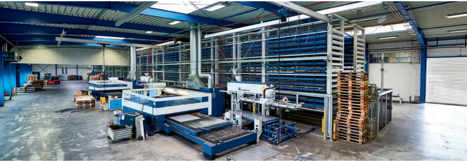
Dreeskornfeld a investi dans un deuxième magasin de tôles automatique, qui est conçu pour quatre formats de palettes système, y compris le maxi-format XF.
