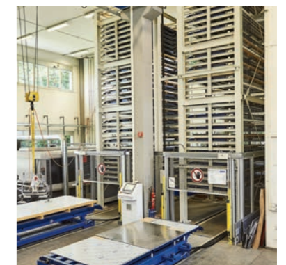
La solution avec deux chariots transporteurs qui stockent et déstockent simultanément permet à Büchel de renforcer sa flexibilité.
