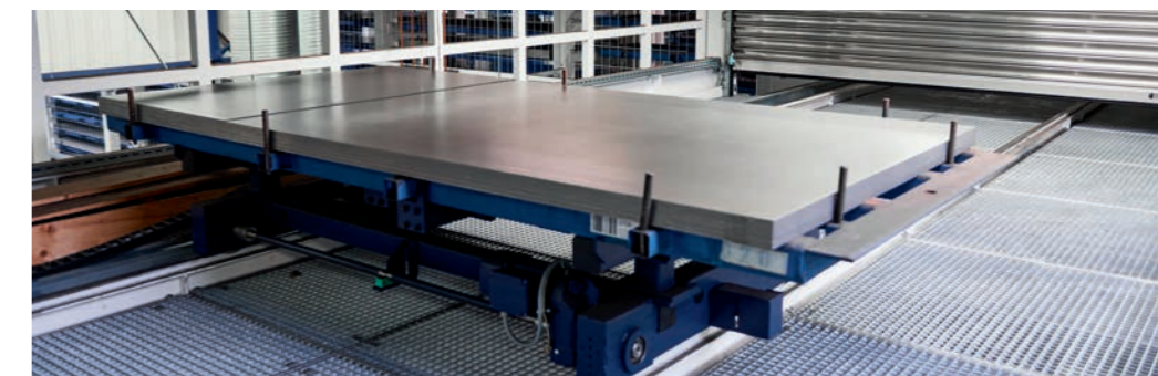
Le trajet de navette qui passe par une passerelle permet d'approvisionner chaque installation de découpe laser depuis les deux magasins de stockage.
