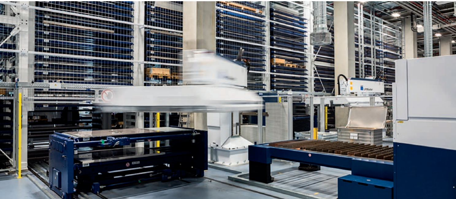
Aesculap a investi dans un magasin de tôles automatique avec un système de gestion des stocks modifié.
