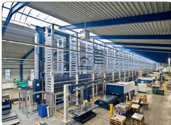
Am Lager angebundene Maschinen werden just-in-time mit Material versorgt. Ein reibungsloser Produktionsablauf ist so garantiert.
