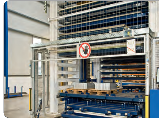
Die Einlagerung von EURO-Paletten ist durch eine spezielle Vorrichtung, welche das Verrutschen verhindert, auch möglich.
