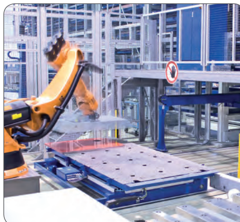
Ein Roboter holt bereits eingelagerte, gelaserte Teile zur Weiterbearbeitung vom Scherenhubtisch.
