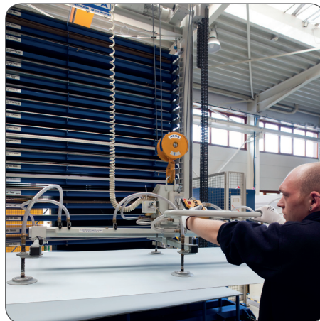
Das Blech wird mittels einer Saugvorrichtung zur Bearbeitung entnommen.
