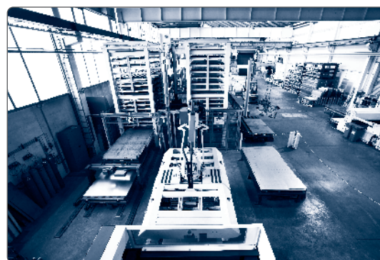
Vor- und Rücklagerung von Materialien über stirnseitige Doppelwagen
