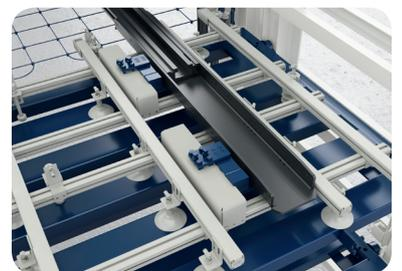
Eine unerwünschte Aufnahme von Doppelblech wird durch eine integrierte Doppelblecherkennung vermieden.
