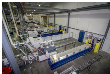
Das Langgutlager versorgt die angebundenen Sägen auf kurzen Wegen über vier Auslagerstationen.
