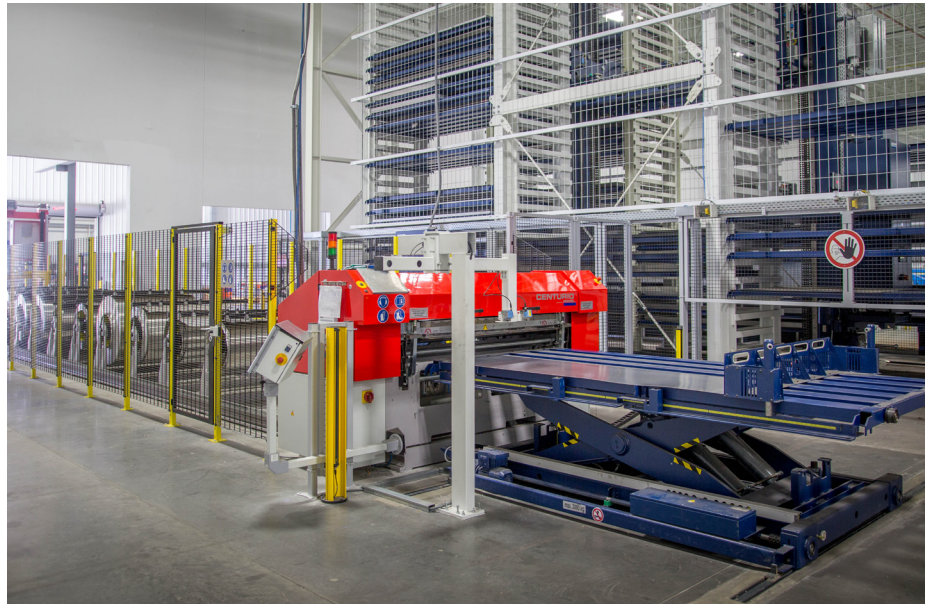
Eine Spaltanlage schneidet das in Form von Coils angelieferte Dünnblech zu und schiebt die Tafeln auf eine Flachpalette, die ein Scherenhubtisch in das STOPA COMPACT Automatiklager fährt.
