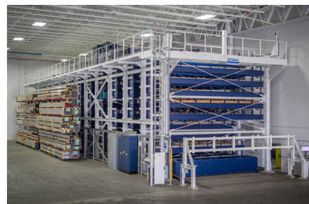
Der wesentliche Vorteil des Langgutlagers liegt darin, dass der Sägerei aufgrund der raumsparenden Lagerung der Profile erheblich mehr Fertigungsfläche zur Verfügung steht.
