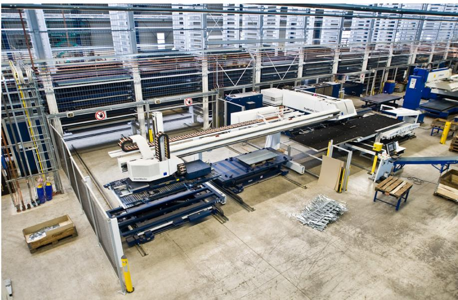
Wegen des größeren Arbeitsbereichs der Handlingkomponente, setzt Schickling an dieser Station parallel verführende Be- und Entladewagen ein.
