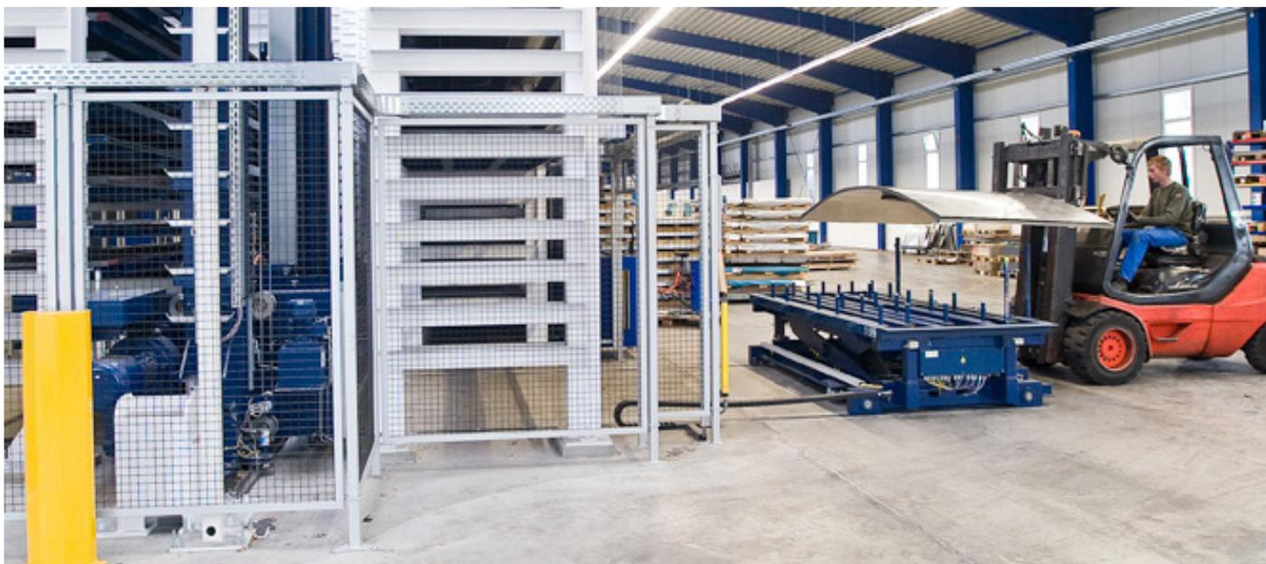
Der Scherenhubtisch der Warenein- und -ausgangsstation ist mit Ablagestempeln und steckbaren Anschlängen für ein Koordinateneck ausgestattet, mit dessen Hilfe man die Tafeln exakt ausrichtet.
