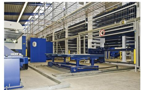
Da die Handlingkomponente dieser Station das Material immer in derselben Position aufnimmt und absetzt, hat STOPA zum Ein- und Auslagern platzsparende, übereinander verlaufende Doppelwagen installiert.
