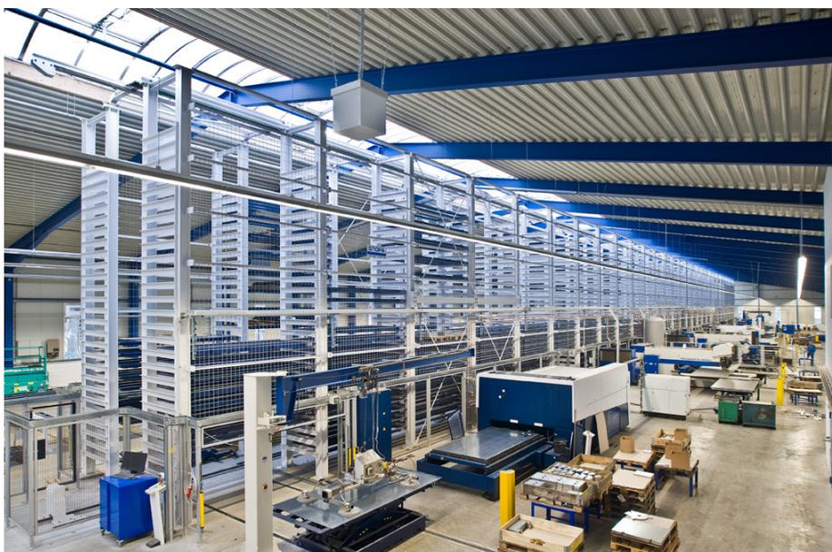
Das in die Produktion von Schickling eingebundene STOPA UNIVERSAL Lager versorgt alle Laserschneid- und Stanzanlagen des Betreibers taktzeitgerecht mit Material.
