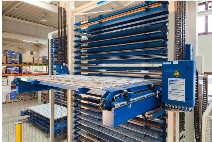
Beide Lagertürme arbeiten mit einer wartungsarmen, stabilen und robusten Zweimast-Lasttraverse, die durch eine Zieh-/Schiebeeinrichtung ein- und auslagert
