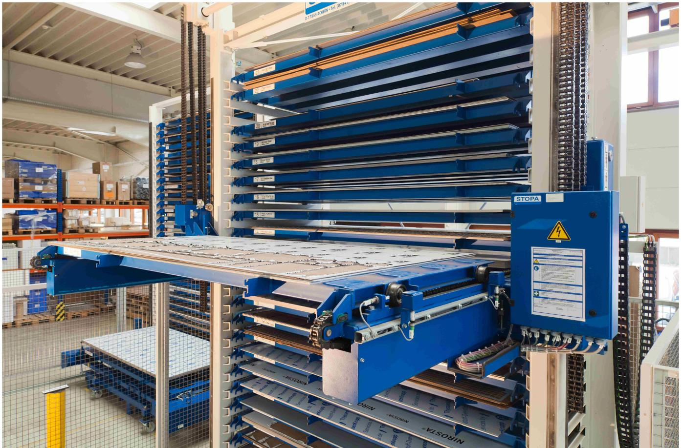
**Les deux tours de stockage utilisent une traverse de charge à double mât robuste et stable, qui stocke et déstocke avec un dispositif de traction et poussée**
