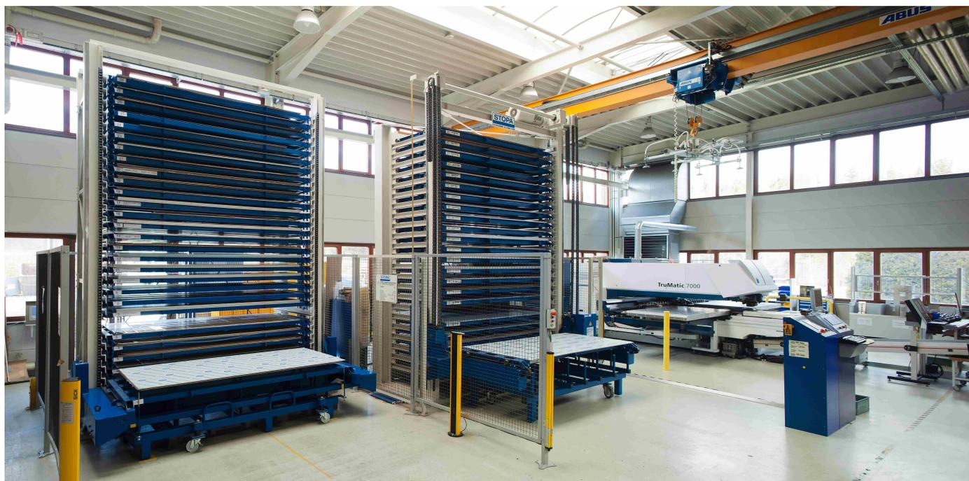
**Les magasins de tôles STOPA TOWER occupent peu d'espace et sont raccordés à l'installation de découpe laser et de poinçonnage de SCHAEFER par des trajets courts**
