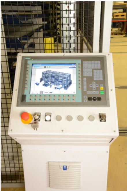
Die Systemsteuerung besteht aus einem Industrie-PC mit integrierter Realtime-Soft-SPS, der zusammen mit einem 12-Zoll-TFT-Display in ein ergonomisches Bedienpult eingebaut ist.
