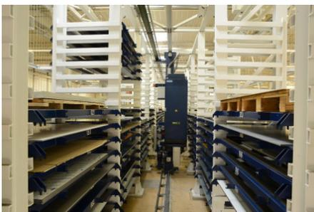
Im Blechlager, das mit 423 Stellplätzen ausgestattet ist, übernimmt ein Zweimast-Regalbediengerät das Handling von 210 Flachpaletten.
