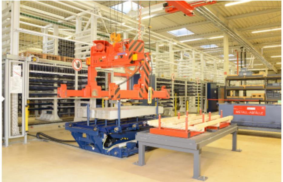
Im Wareneingang hebt ein Brückenkran die Blechpakete von den Holzpaletten, auf denen sie angeliefert werden, und setzt Sie auf die Ablagegestempel des Scherenhubtisches.
