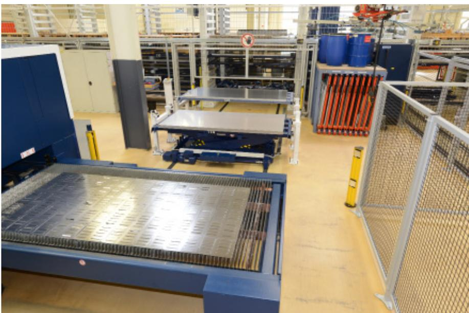
Das Automatiklager versorgt die 2-D-Laserschneidanlage über einen Scherenhubtisch und zwei hintereinander angeordnete Ablagegestelle.
