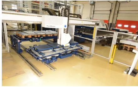
STOPA hat eine Lösung entwickelt, bei der ein Scherenhubtisch die Stanzmaschine mit Rohblechen beliefert und ein Transportwagen in Portalbauweise, der über den Scherenhubtisch hinwegfährt, fertige Teile in das Lager transportiert.
