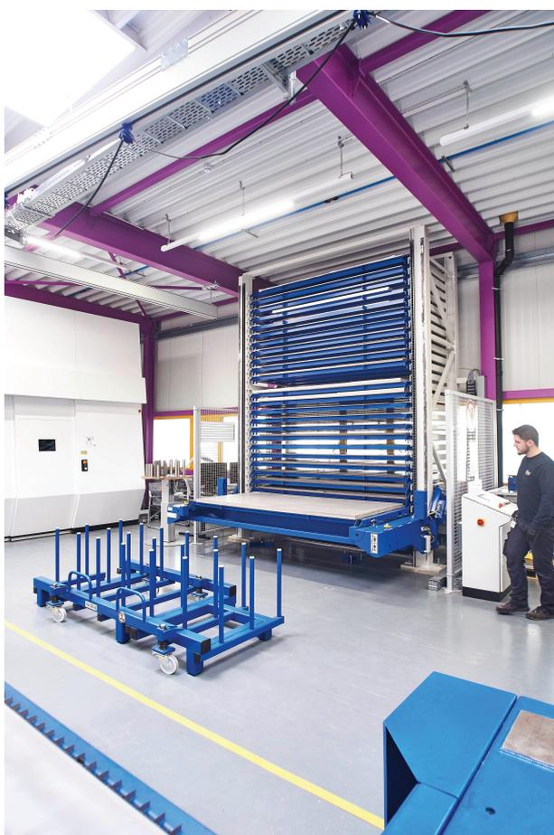
**Axel Ausländer déclenche les déstockages de matériau en saisissant sur le pupitre de commande central le numéro du casier à partir duquel la palette doit sortir pour se mettre en position de prélèvement.**
