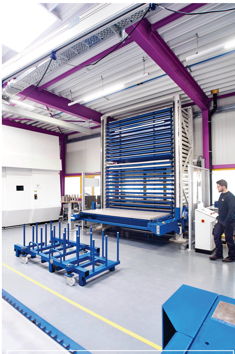
Axel Ausländer lässt eine Systempalette vorlagern, indem er am zentralen Anlagenbedienpult die Start- und Zielkoordinaten eintippt
