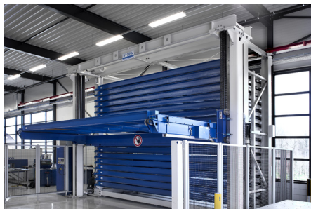
Im STOPA TOWER Mono SF liegen Blechtafeln in Sonderformaten bis 6.000 Millimeter Länge.
