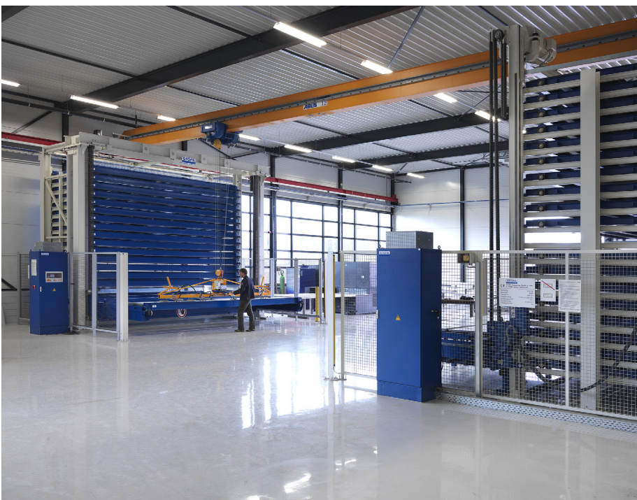
Florigo puffert seine Rohblechtafeln in zwei STOPA TOWER Mono Lagertürmen.
