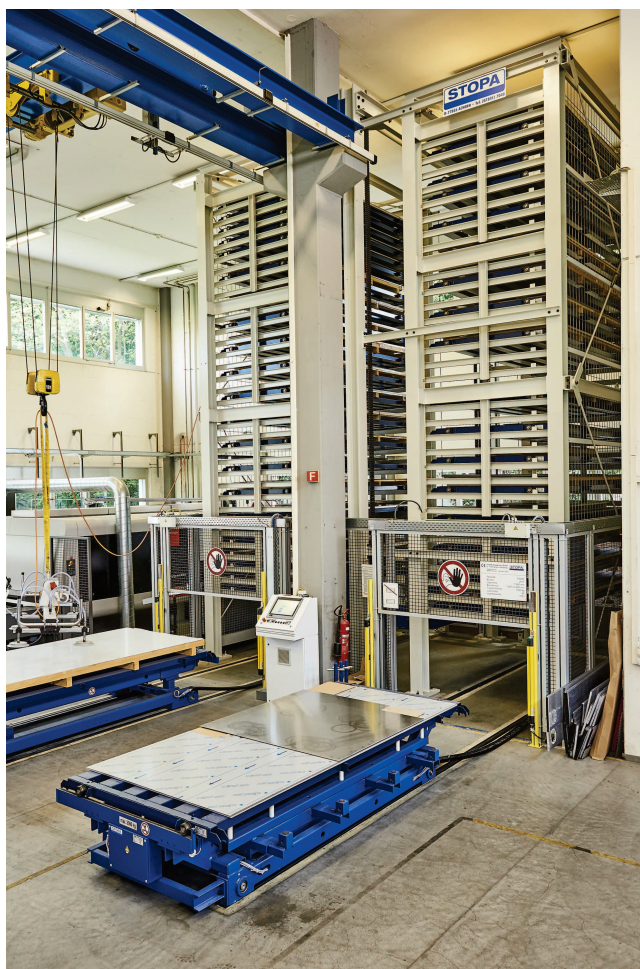
La solution avec deux chariots transporteurs qui stockent et déstockent simultanément permet à Büchel de renforcer sa flexibilité.
