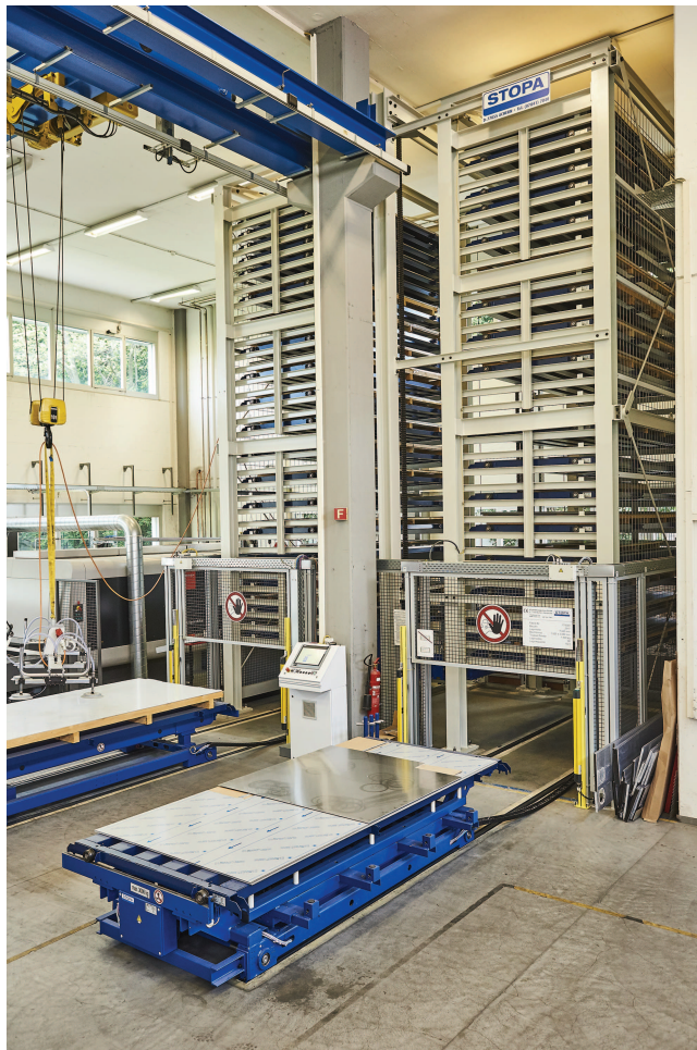
Durch die Lösung mit zwei Transportwagen, die zeitgleich ein- und auslagern, steigert Büchel seine Flexibilität
