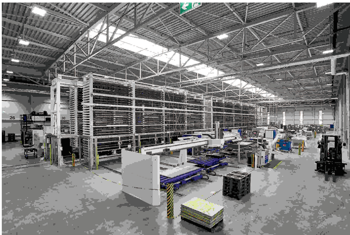
Chez BINDER, le magasin de tôles automatique STOPA COMPACT II joue le rôle de centre logistique interne
