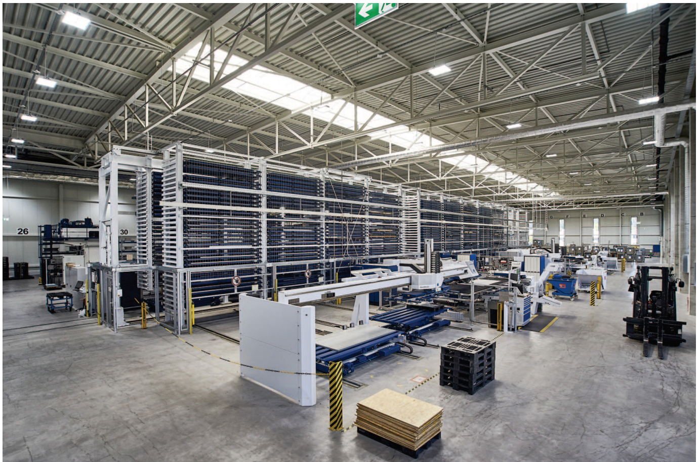
Das automatische STOPA COMPACT II Blechlager fungiert bei BINDER als internes Logistikzentrum
