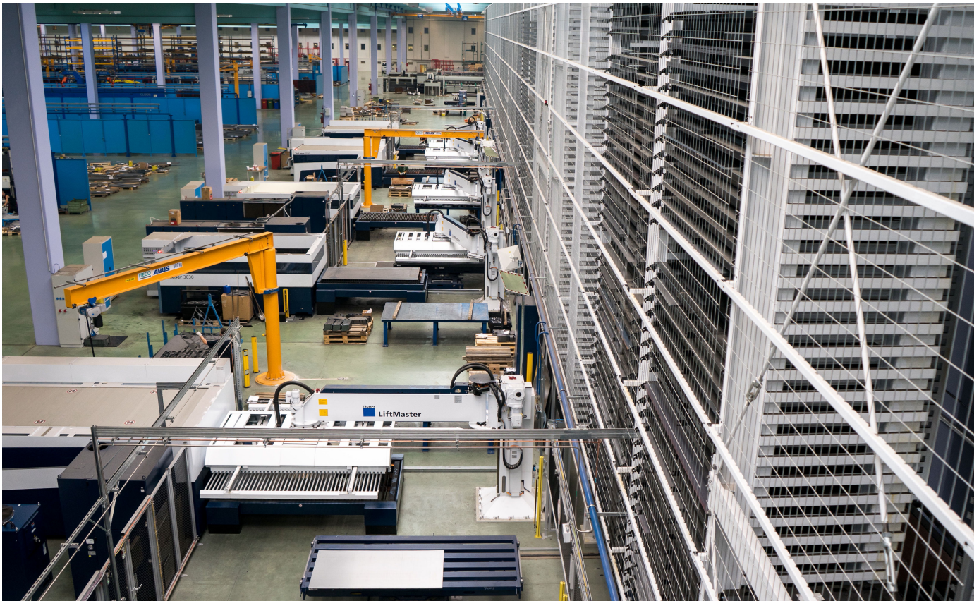
Die Dreheinrichtungen der Beladestationen stellen die Tafeln platzsparend bereit, sodass sich eine größere Zahl an Laserschneidanlagen anbinden lässt
