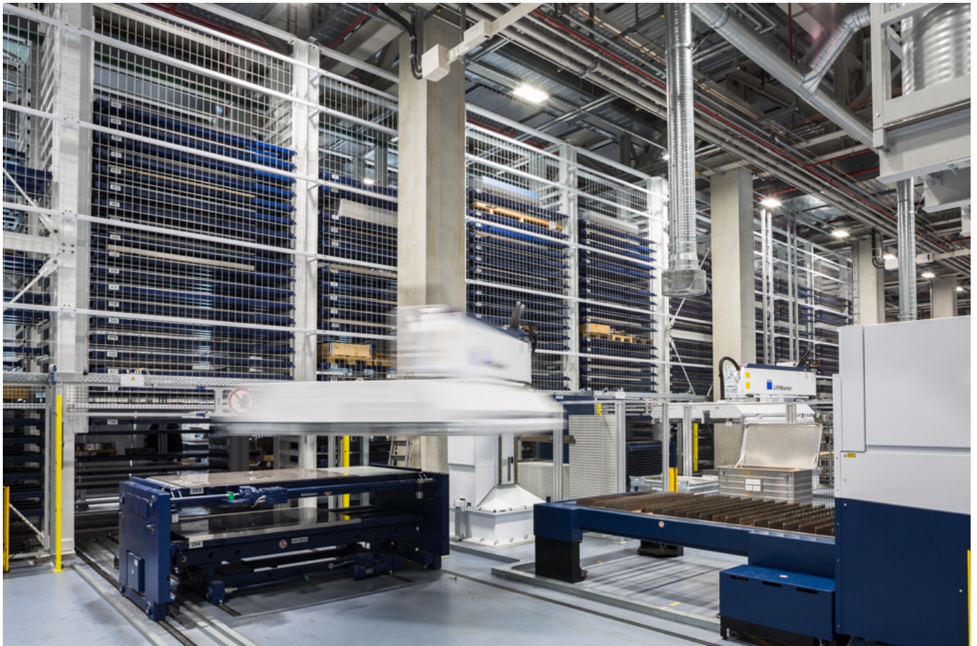
Aesculap a investi dans un magasin de tôles automatique avec un système de gestion des stocks modifié
