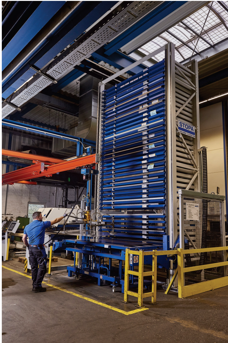
Der Bediener lässt die Systempalette aus dem Turm fahren und hebt die Blechtafeln mit dem Kran ergonomisch ab
