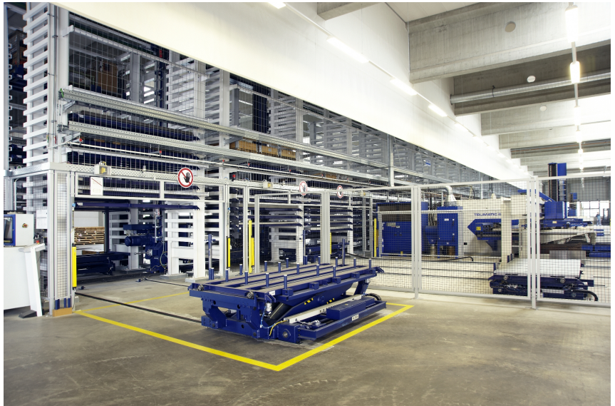
Das Automatiklager STOPA COMPACT ist bei WaCo rund 67,5 Meter lang, 4,7 Meter breit und 6,2 Meter hoch
