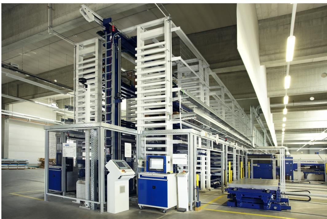
**Le transstockeur atteint en course longitudinale une vitesse de 150 mètres à la minute, de 23 mètres/min pour le levage et de 20 mètres/min pour la poussée et**
