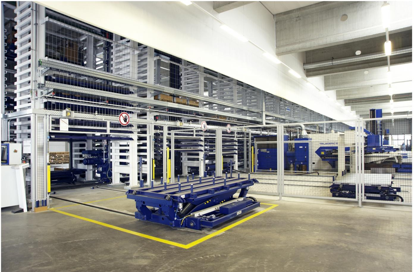
**Le système fait environ 67,5 mètres de long et se compose de 40 tours de stockage agencées sur deux rangées qui, abstraction faite des stations, abritent 804 emplacements de stockage**
