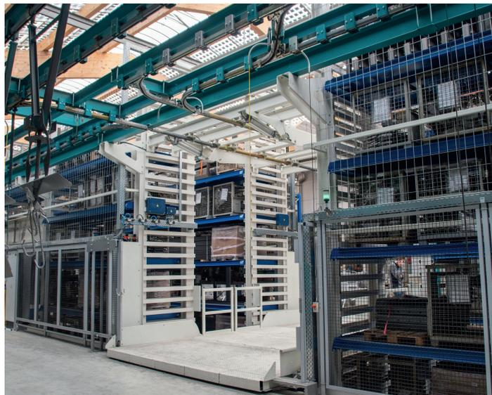
**Les halls de production et de montage sont reliés entre eux par le magasin et par un système de voie suspendue à commande manuelle**
