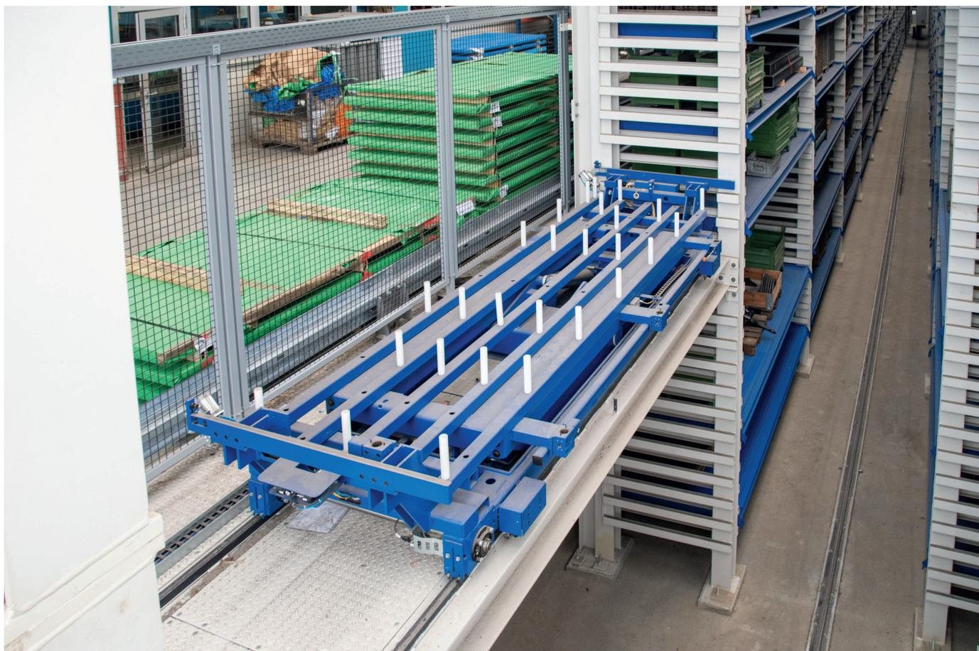
**STOPA a également installé un chariot de transport alimenté en énergie par des accumulateurs et qui circule sur rails sans chaîne de transmission d'énergie**
