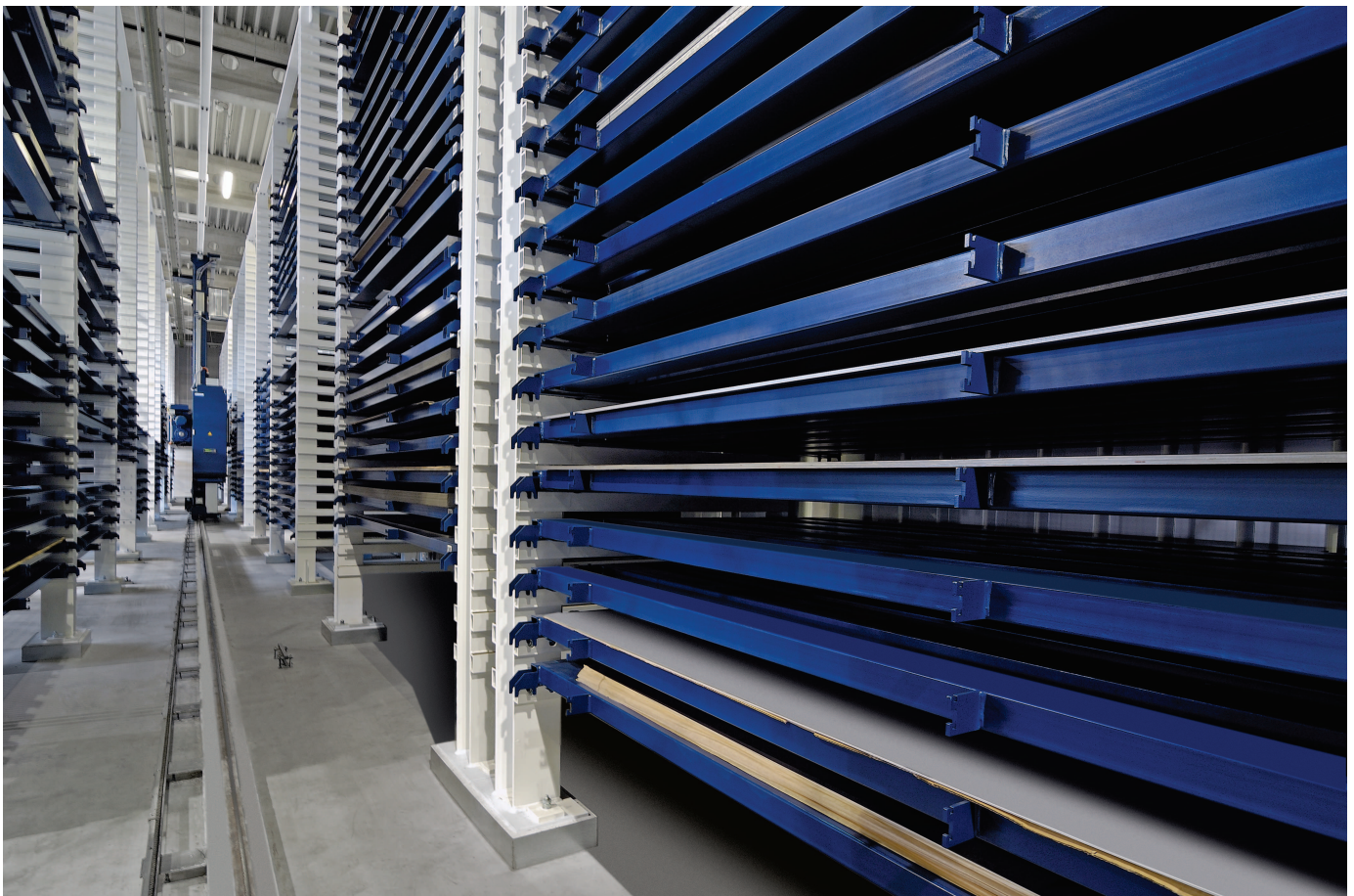
Die Bewegungen des STOPA COMPACT Blechlagers lassen sich flexibel auf das ein- und auszulagernde Material abstimmen
