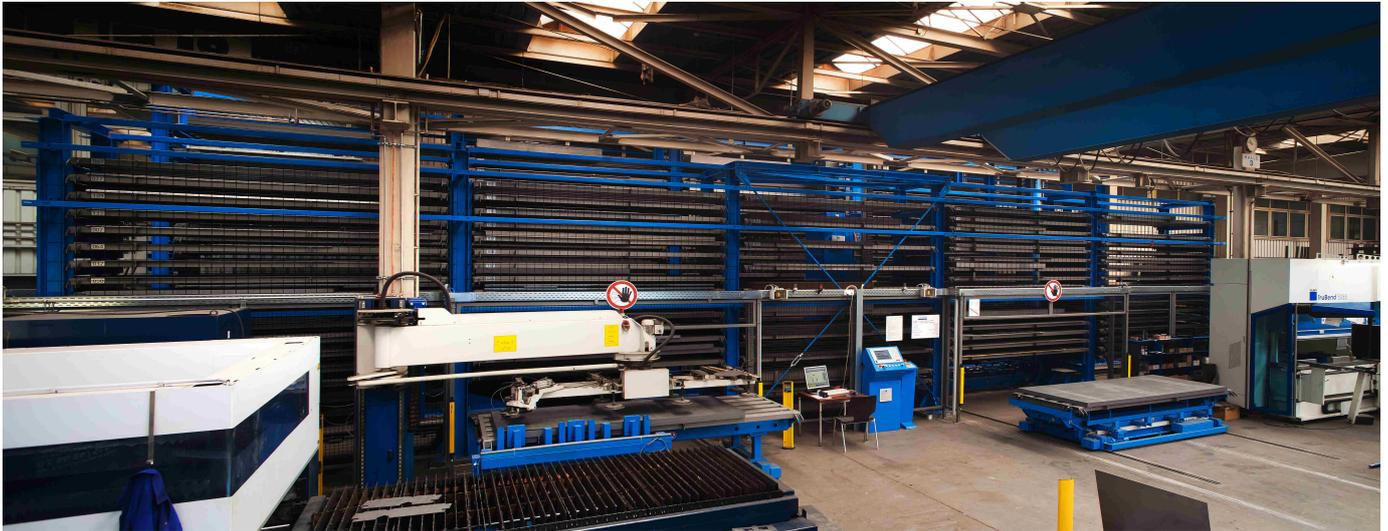
**Die TRUMPF Laserschneidanlage wird über einen Transportwagen und eine Ladeeinheit automatisch mit dem Blechlagersystem verbunden**
