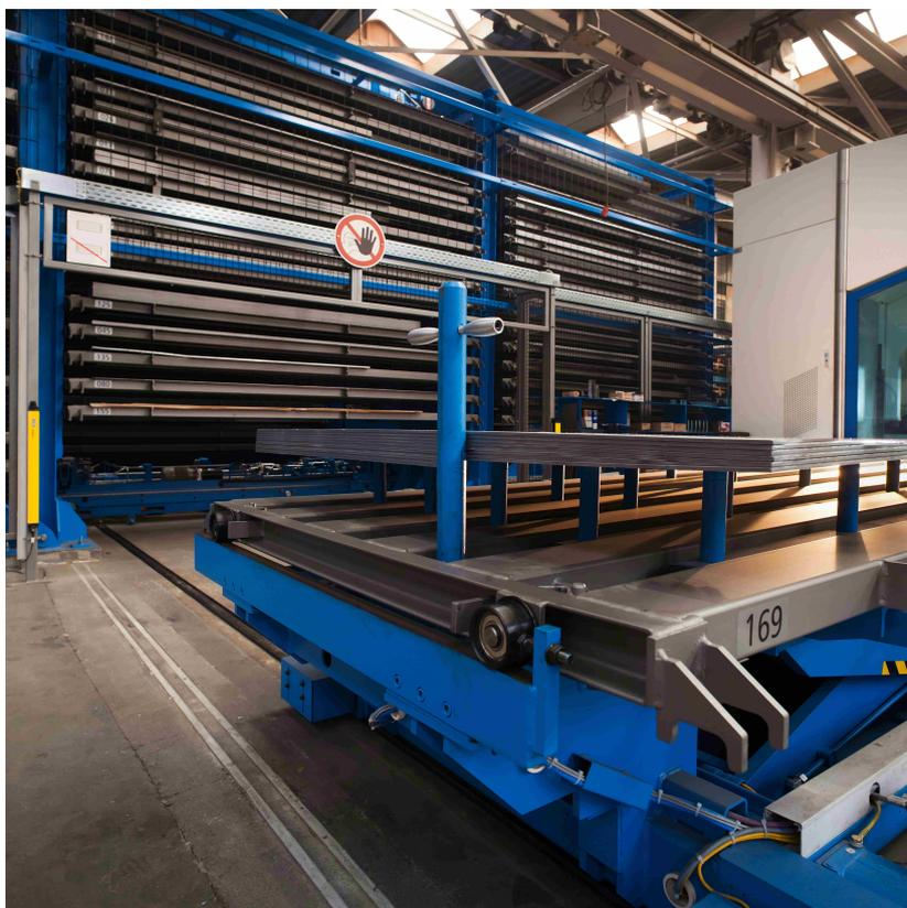
**Der Scherenhubtisch nimmt das Blechpaket auf seinen Ablagestempeln auf und senkt es mithilfe der Stempel auf eine Systempalette ab**
