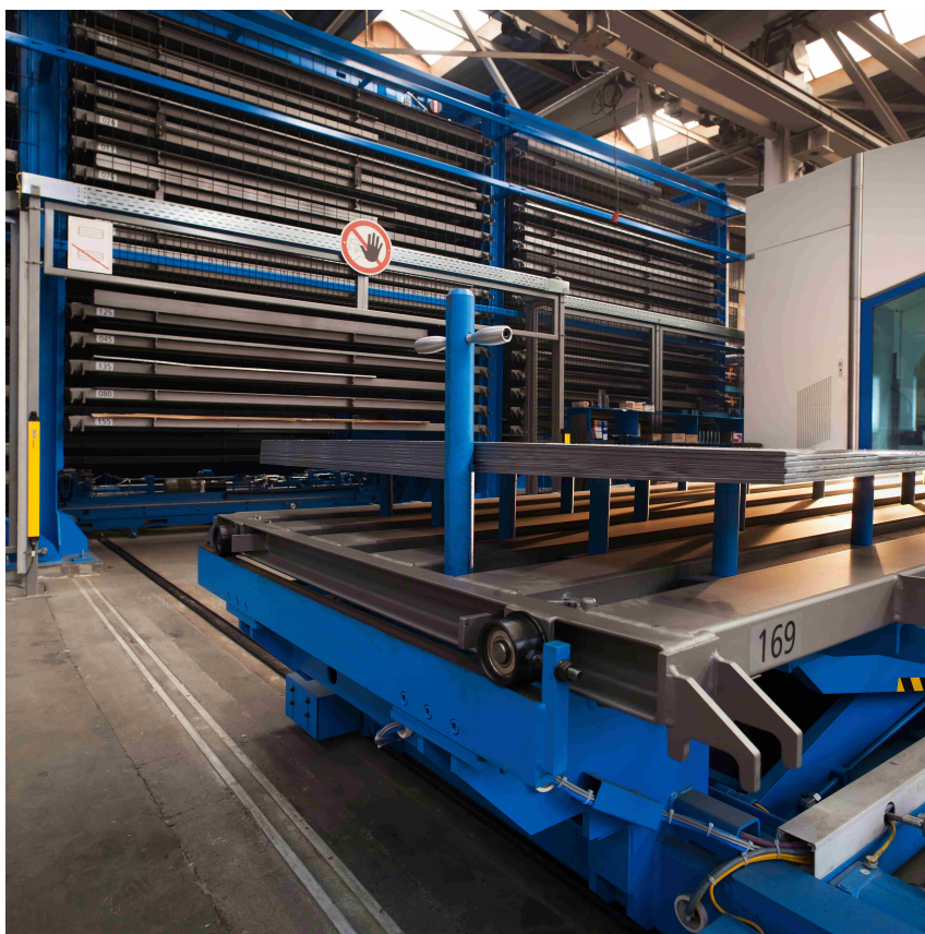
La table élévatrice à leviers croisés accueille le paquet de tôles sur ses broches de dépose et l'abaisse avec les broches sur une palette système
