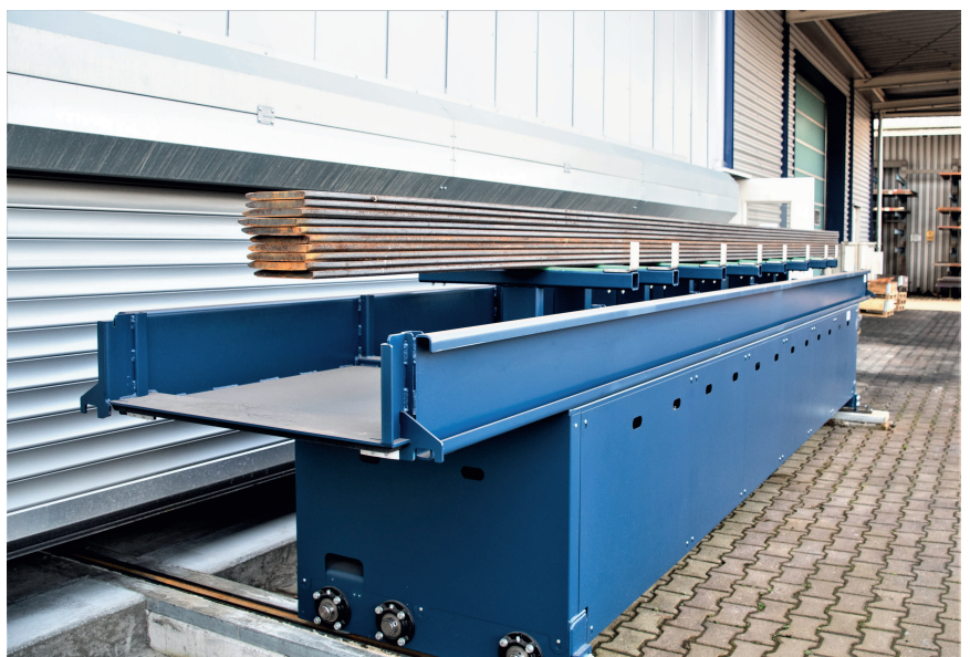
STOPA kann das Langgutlager im Halleninnern direkt an einer Außenwand aufstellen und einen Transportwagen durch ein Rolltor direkt ins Freie fahren lassen
