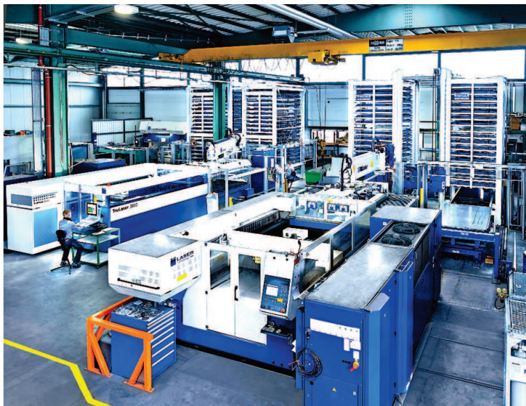
Die stirnseitige Be- und Entladestation des Lagers ist mit je einem Ober- und Unterwagen sowie mit der automatischen Be- und Entladeeinrichtung LiftMaster ausgestattet
