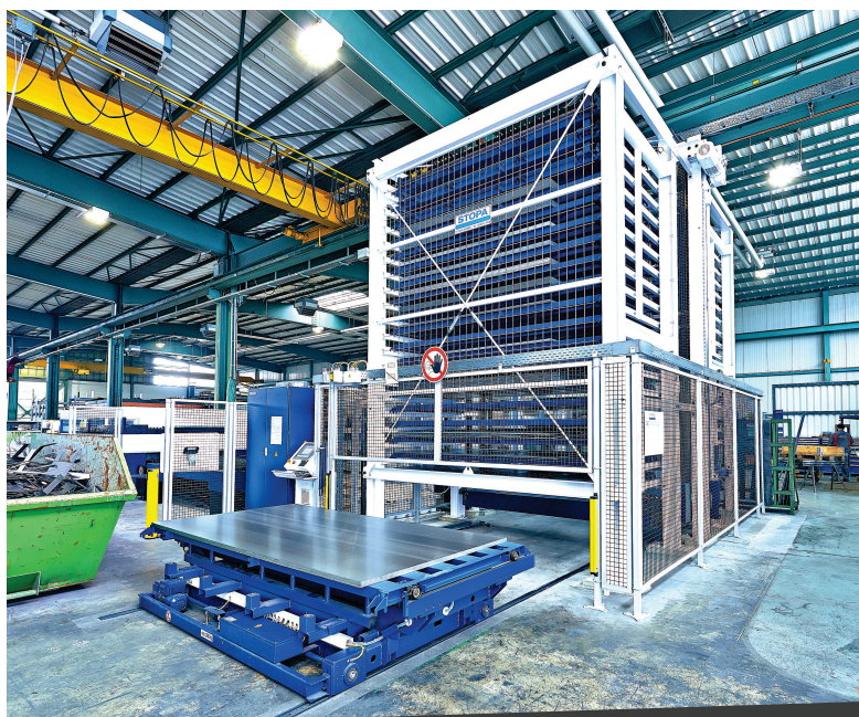
An den beiden Turmlagern sieht man beispielhaft, wie kompakt sich Blechtafeln auf einer relativ kleinen Fläche lagern lassen
