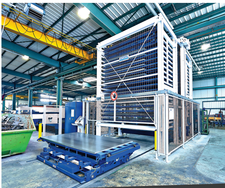
Les deux tours de stockage montrent de manière exemplaire à quel point le stockage de feuilles de tôle peut être compact sur une surface relativement réduite
