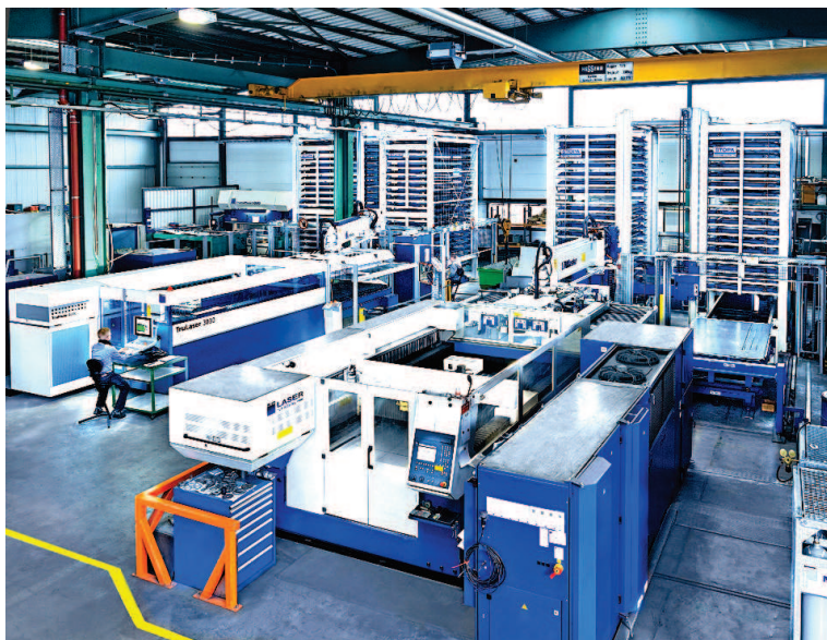
La station de chargement et de déchargement sur la façade du magasin est équipée d'un chariot supérieur et d'un chariot inférieur, ainsi que du dispositif automatique de chargement et de déchargement LiftMaster
