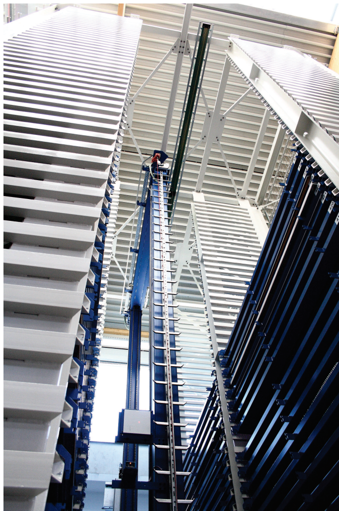
Das STOPA COMPACT II Blechlager verbindet intralogistisch zwei Stockwerke miteinander
